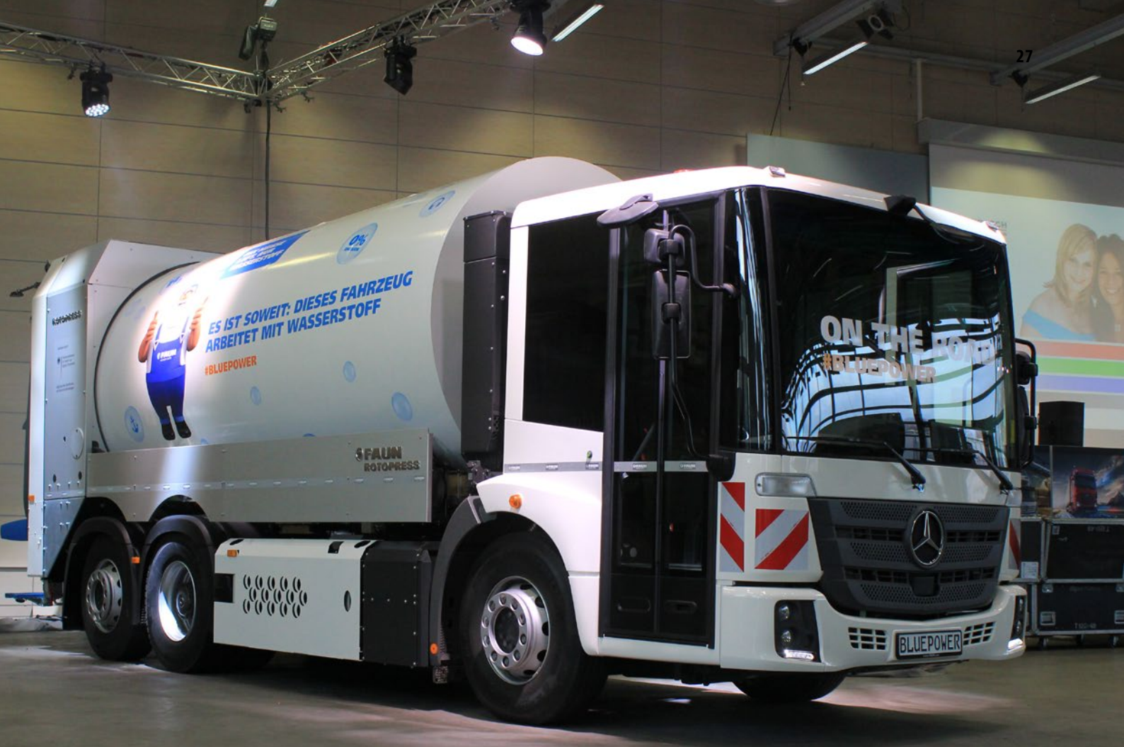
► Abb. 1 / Das Abfallsammelfahrzeug „Rotopress Bluepower“ mit Wasserstoff-Brennstoffzellenantrieb.
