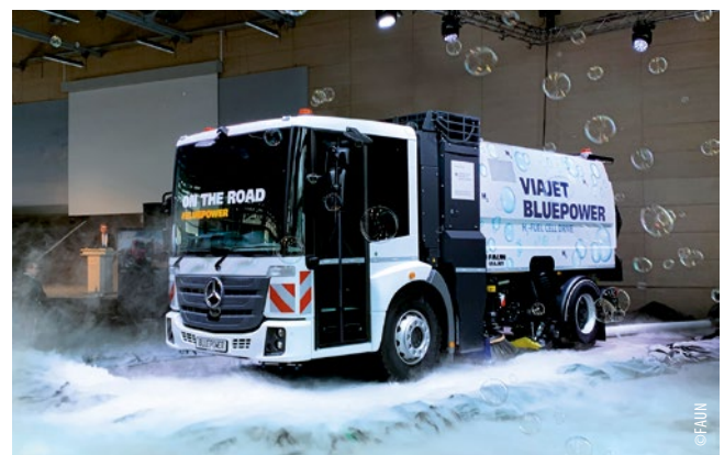
► Abb. 2 / Die Kehrmaschine „Viajet Bluepower“ mit Wasserstoff-Brennstoffzellenantrieb ist als 2-Achser konzipiert. Sie hat ein Fassungsvermögen von 6 m 3 und kann für einen 10-Stunden-Betrieb genutzt werden. Der Hauptantrieb versorgt bei den Kehrmaschinen auch den Antrieb von Bürsten und Saugern.
